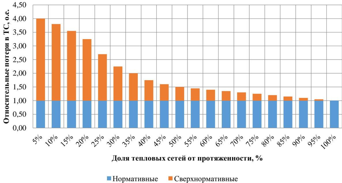
**Рисунок 9.1 – Распределение тепловых потерь в тепловых сетях**
